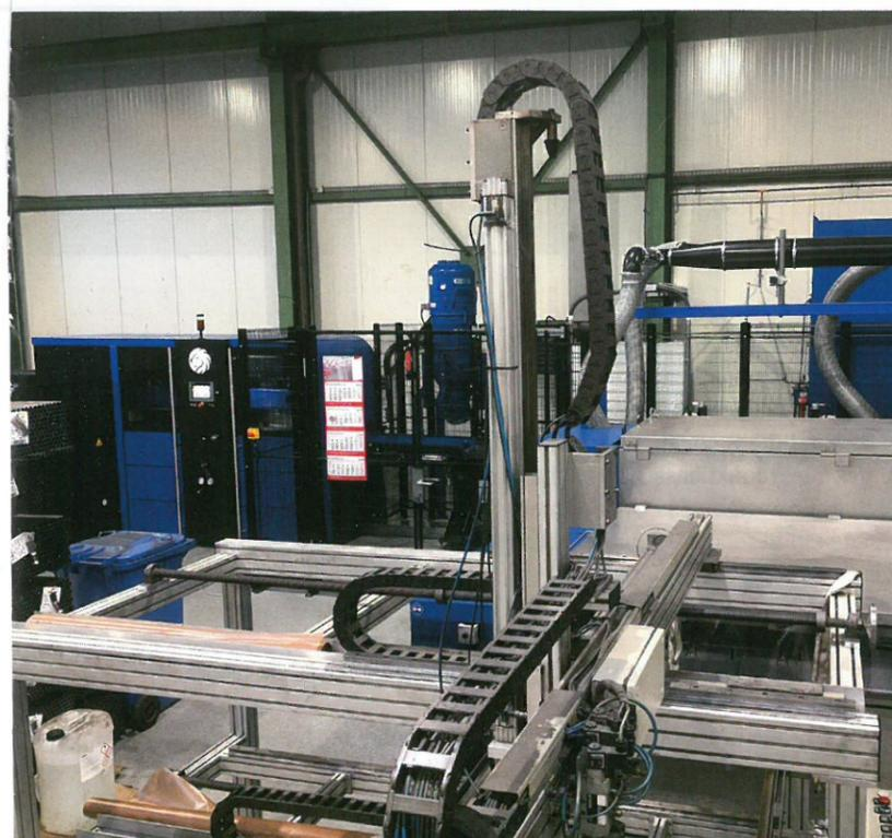
Auf in die Zukunft geht es auch mit der neuen RSA-Sägeanlage. Diese Maschine mit Doppelschnitt (damit können zwei Rohre gleichzeitig geschnitten werden) bewältigt 2.000 Schnitte pro Stunde. Zudem besitzt die Maschine eine integrierte Bürstenentgratung und einen Wasch- und Trocknungsautomat.
